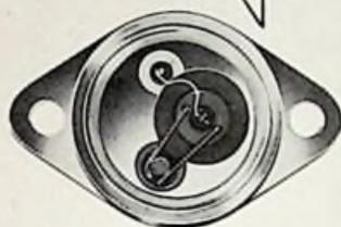
Geringer Grenzwiderstand  $R_{CS}$  (0,05 $\Omega$ ) bei hohen Temperaturen infolge der grossen Emitter-Basis Fläche in Ringform. Der Kollektorreststrom wird durch geschweissten Aufbau unter Vermeidung von Verunreinigungen durch Lötzinn und Flussmittel äusserst klein gehalten.
