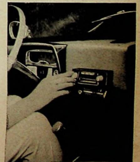
Bild 2. Das Gerät wird im Kraftwagen in eine fachartige Haltevorrichtung eingeschoben und dabei automatisch an die Fahrzeugantenne, die Bordbatterie und gegebenenfalls an einen größeren Wagenlautsprecher angeschlossen
